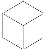
というように見える . この図は 3 次元空間から平面  $x + y + z = 0$  への射影を描いたものであり,  $(1, 1, 1)$  の方から見える立方体の 3 つの面が 3 つの菱形となって現れている ( 裏側の 3 つの面はこれらを 120 度回転したものになる ) . この射影によって, 3 次元空間内に立方体を積み上げた状態は平面上の菱形によるタイル張りに対応する ( 図 7 ) .
