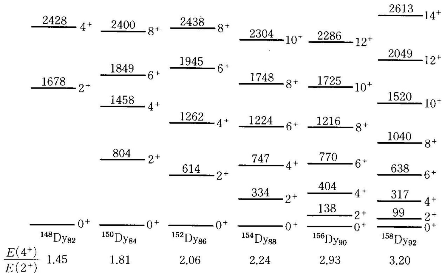
図 3-4 Dy アイソトープの低励起スペクトル. 励起エネルギーの単位は keV.
