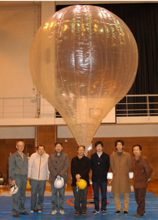
80ミクロン厚ポリエチレンでの試作 ミニバルーンの構造を決定
