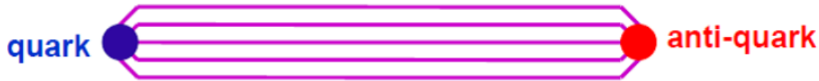
図 1.1 QCD におけるゲージ不変な q\bar{q} 系で形成されるフラックス・チューブの概形。クォークと反クォークの間に、1 次元的に絞られたカラー電場のフラックス・チューブが形成され、線形の閉じ込めポテンシャルが生じる。
