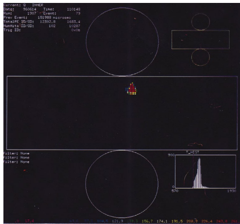
図 4-1. ミュー粒子がS-Kに入射したとき。 図 4-2. 50 ナノ秒後。
