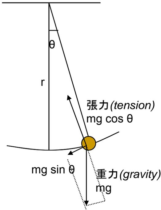
接線方向の運動方程式:  $m \frac{dv}{dt} = -mg \sin \theta$
