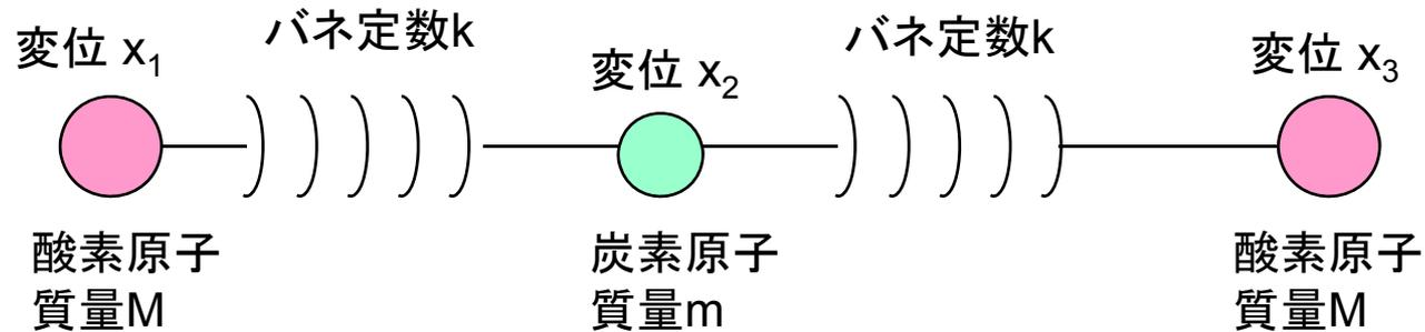
運動方程式:  $M\ddot{x}_1 = -k(x_1 - x_2)$ ,  $m\ddot{x}_2 = -k(2x_2 - x_1 - x_3)$ ,  $M\ddot{x}_3 = -k(x_3 - x_2)$
