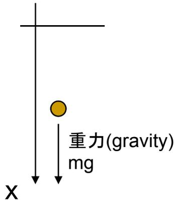
質量 $m$ の物体の自由落下運動(*free-falling motion*)
