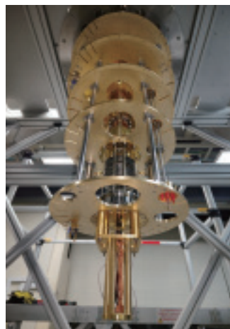
図1：絶対温度5ミリケルビンを実現する希釈冷凍機の内
