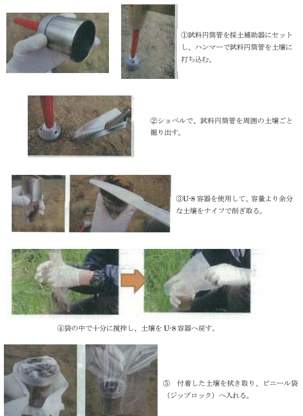
図 3.3 (b) 固い土壌での採取方法
