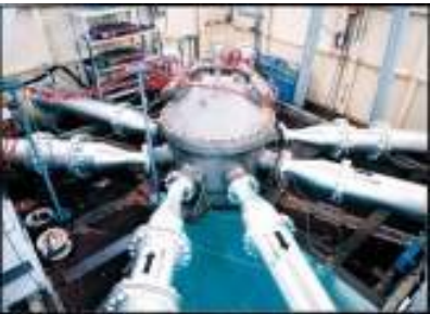
APWR炉内流動試験設備
