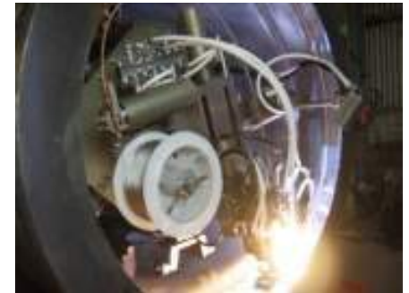
原子炉容器出口管台 内面クラディング状況
