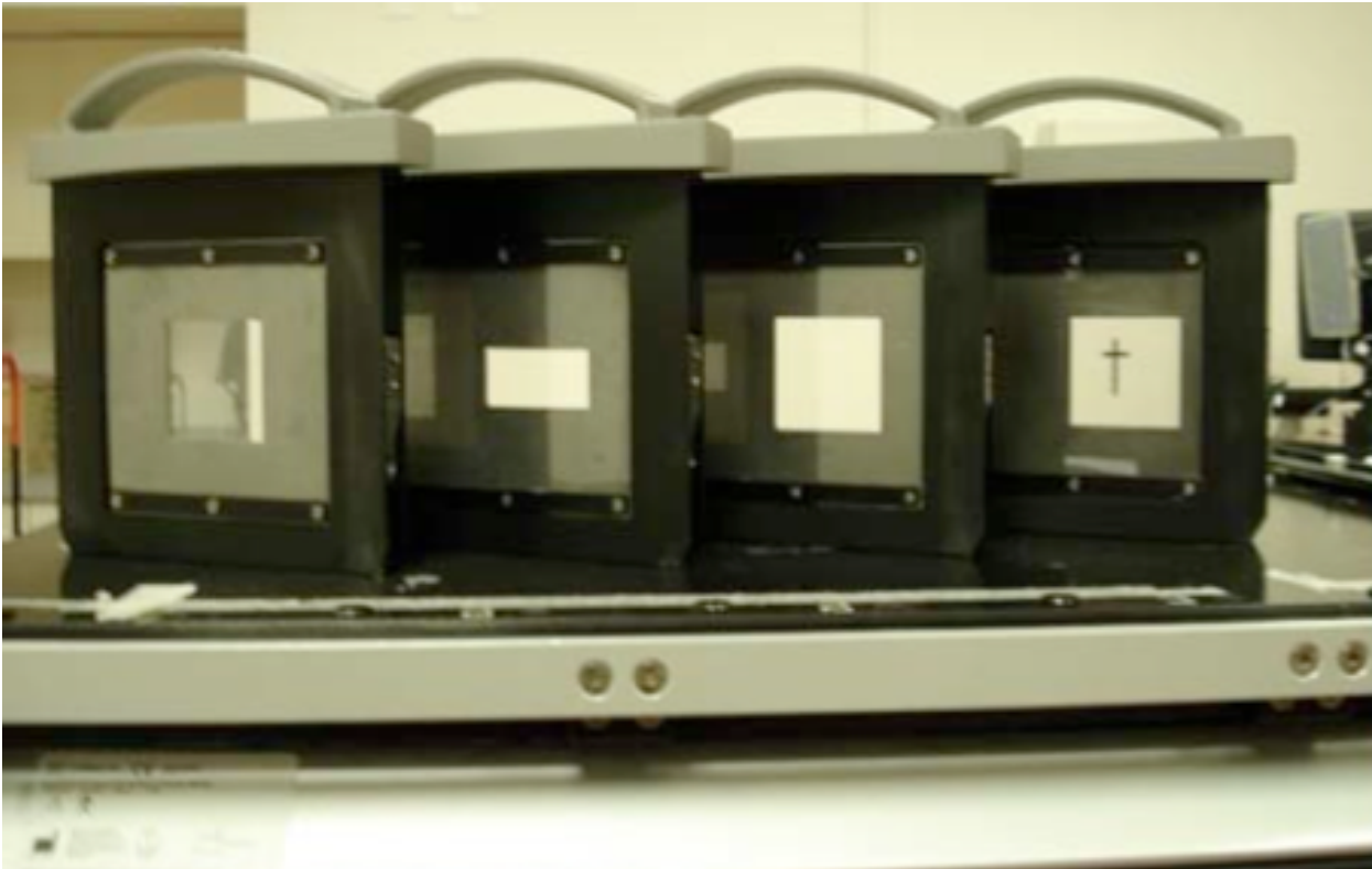
Cone beamの照射領域を調節するため X線出射口にとりつけるコリメータ
